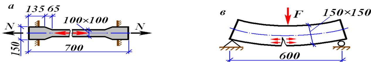
Сурет 7 - Созылуға бетонның беріктігін анықтау үшін үлгілерді сынау сұлбалары
