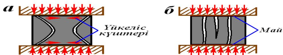
Сурет 4 - Бетонды текшелердің қирау түрі: а-тірек жазықтығы бойынша үйкелісте;
