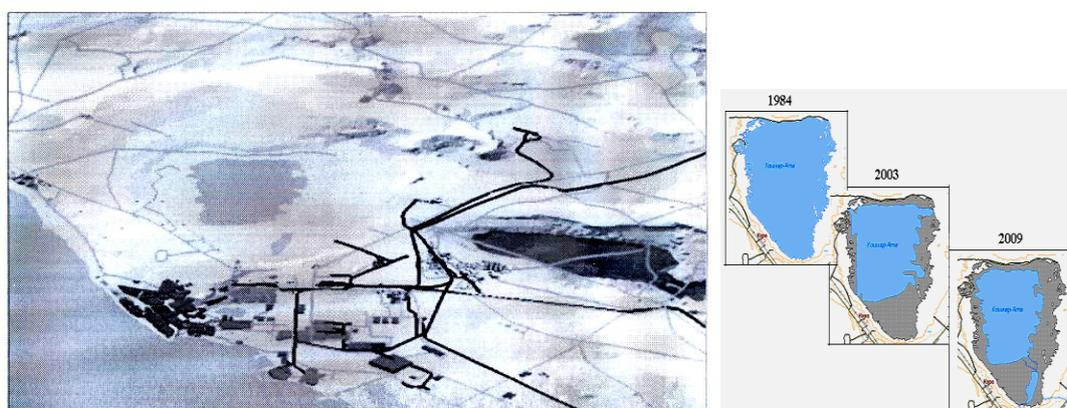
Рисунок 1 - Обзорная карта хвостохранилища Кошкар-Ата с видом обнажившейся в разные годы поверхности водной фазы
