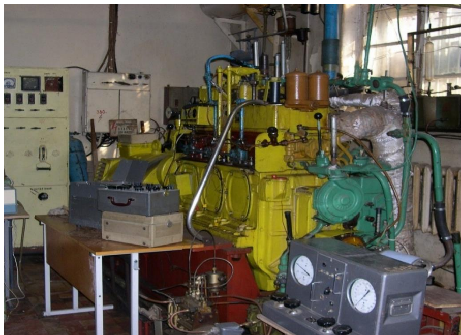
Рисунок 1 - Общий вид экспериментальной конструкции с дизелем 3Ч17,5/24.
