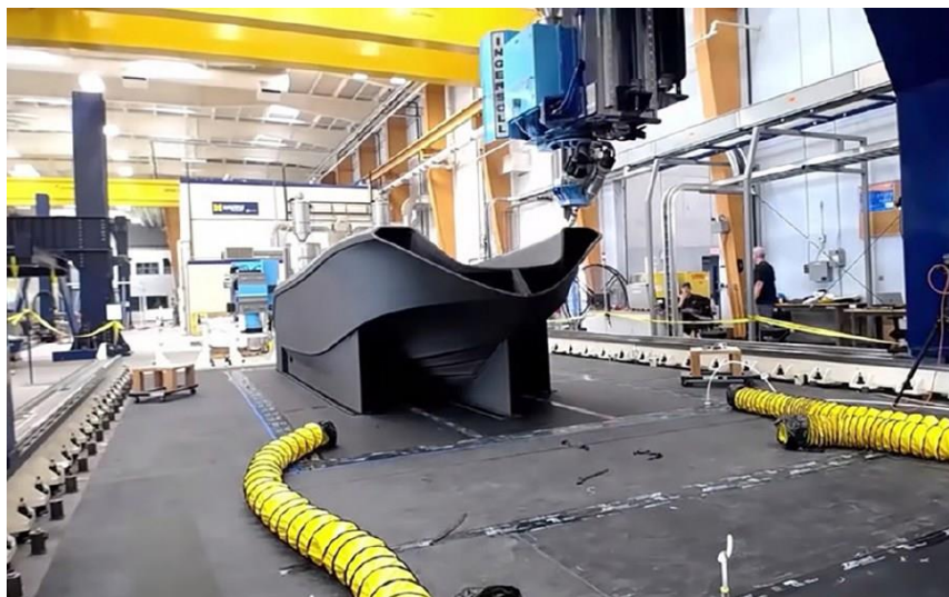
Рисунок 1 – Изготовление корпуса катера с помощью 3D-печати.
