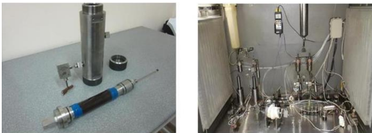
Рисунок 1 – Лабораторное оборудование и схема проведения керновых исследований по вытеснению нефти
